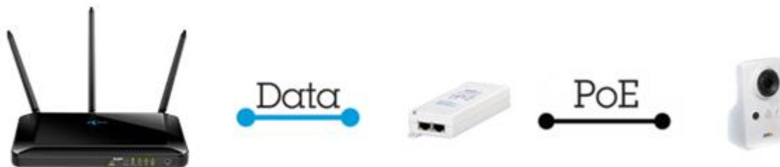
Figur 1: Oppsett av videokamera med PoE injektor
